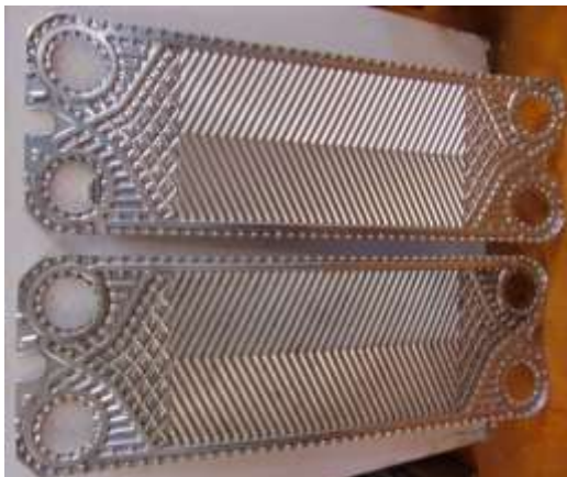
Wärmetauscherplatten vor und nach Reinigung
